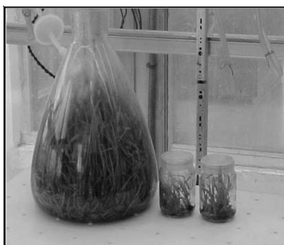
Figura 1. Sistema de inmersión temporal empleado para la micropropagación de diferentes genotipos de caña de azúcar.
