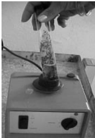
Figura 2. Preparación de suspensiones conidiales de Pseudocercospora fijiensis mediante la utilización del Vortex.
