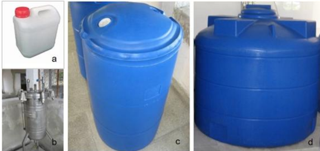
Figura 1. Recipientes empleados como fermentadores para el escalado de bioproducto de origen microbiano por fermentación. a. 5 litros, b. 24 litros, c. 200 litros, d. 2100 litros.
