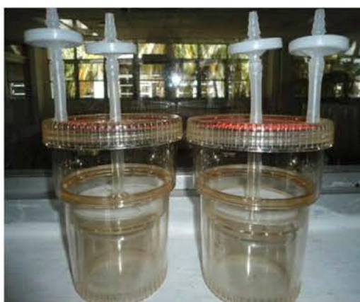
Figura 1. Sistema de inmersión temporal RITA empleado en la multiplicación de B. vulgaris .
